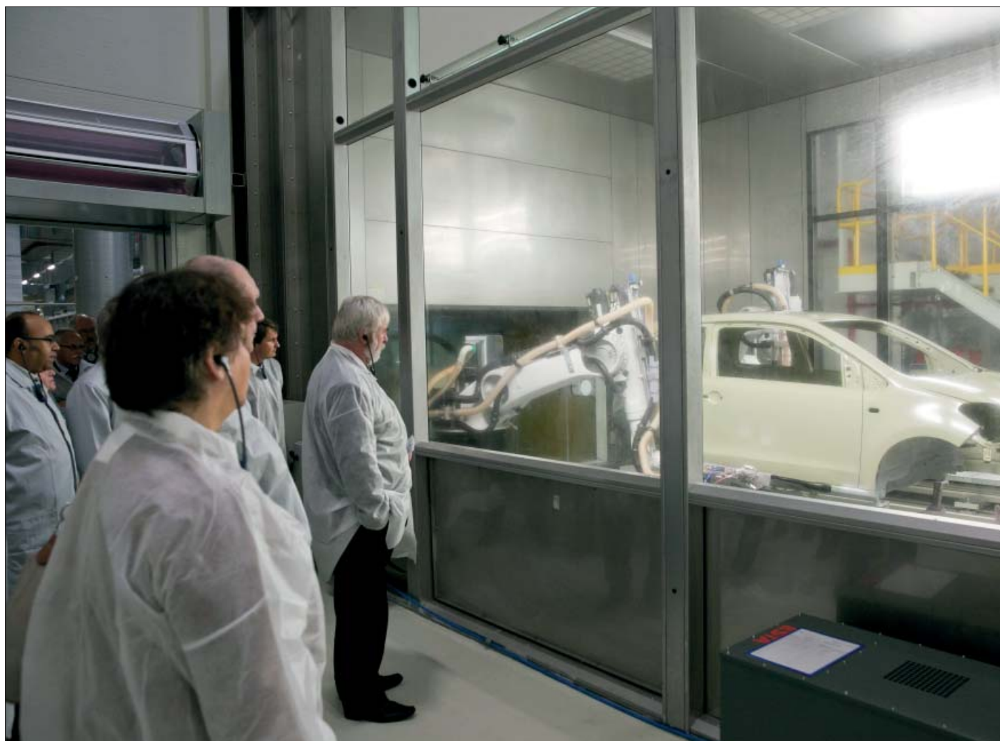
Počas prehliadky lakovne - Čistenie karosérie robotickými obežnými kefami ušetrí 30 až 60 m 3 vody denne. Táto technológia na čistenie využíva uzavretú kabínu, kde robotické kefy čistia a oprašujú celú karosériu. Následne karoséria prichádza do striekacích kabín, kde sa nanáša základná farba. Tento nový proces čistenia znižuje spotrebu vody, šetrí energiu potrebnú na jej úpravu a vyčistenie i na vysušenie karosérie po procese čistenia.
